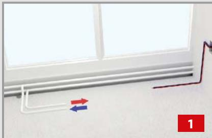
**3. Вариант 2.** В случае оформления индивидуального заказа на угловые ножки с фиксацией к полу, к действиям варианта 1 добавить фиксацию к полу углов прибора.
