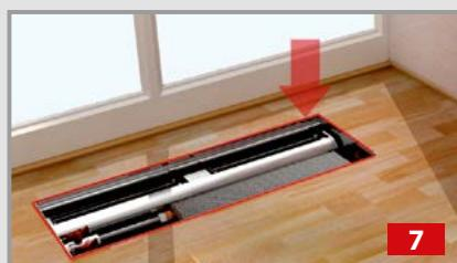
**3. Вариант 1.** Установить прибор в канал, выровнять по уровню горизонта с помощью регулировочных болтов (углы), регулировочных уголков (посредине). Зафиксировать уголки к полу. Верхняя часть прибора должна совпасть с "чистовым полом".
